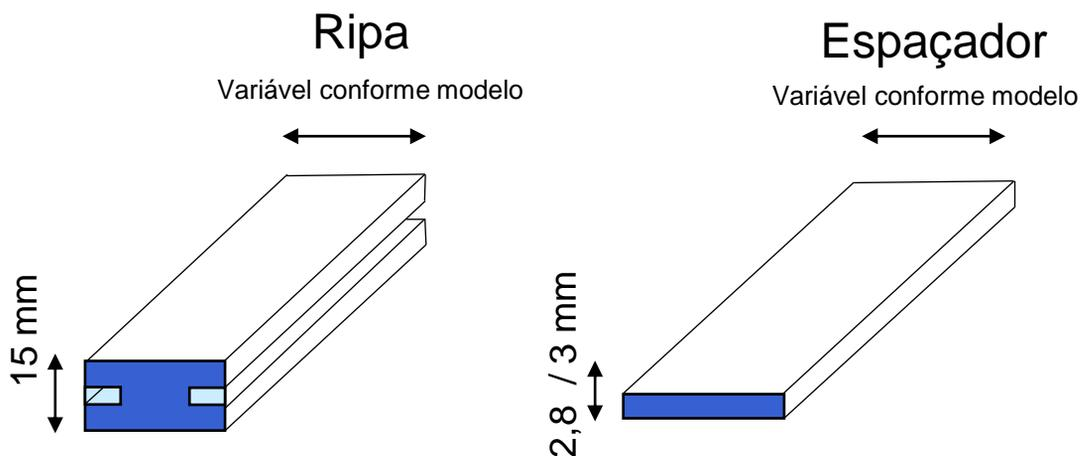
As alturas das barras dos ripados e espaçadores tem o comprimento de 2,7 metros, em caso de alturas superiores é indicado que sejam feitas emendas. A Barreto sugere que estas emendas sejam feitas de forma que fiquem desencontradas para um melhor acabamento
